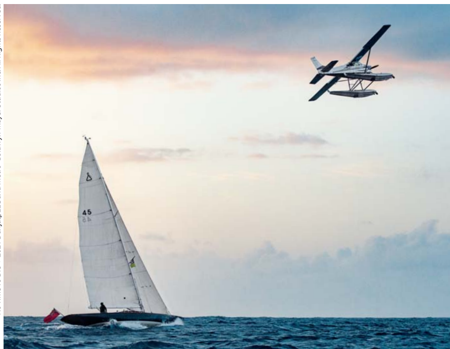
Šalupa s takelází typu „Fractional Rig“ má přední plachtu uchycenou výrazně pod vrcholem stěžně.
